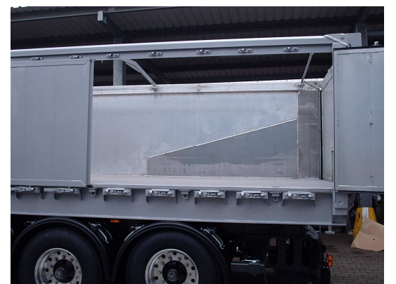
Kipp- oder Schubbodenaufbauten mit seitlichen Türen zum Beladen mit Langgut
