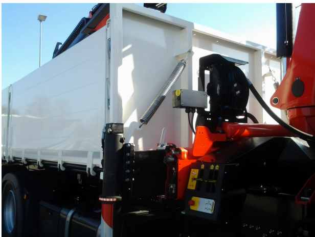
Baustoffpritsche mit Federunterstützung vorne und hinten
