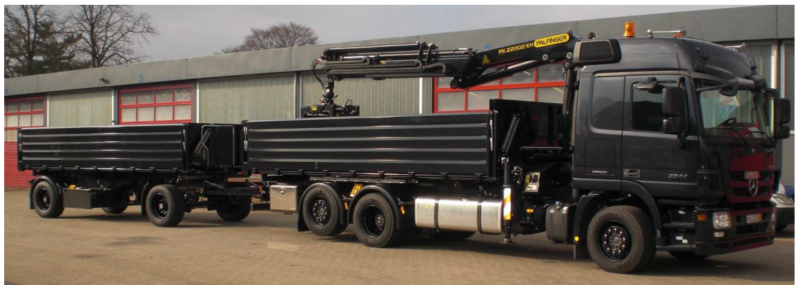
Kipp- oder Schubbodenaufbauten mit seitlichen Türen zum Beladen mit Langgut
